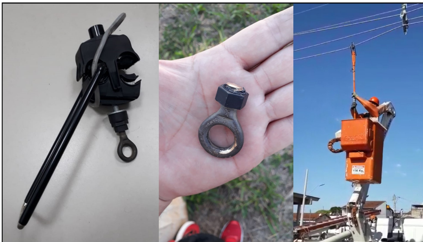
Figura 5 – Imagens do teste com olhal instalado na porca torquimétrica
